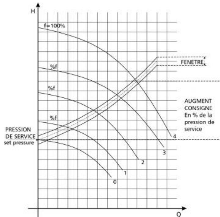
L'Hydrovar peut compenser automatiquement les pertes de charge par frottement intervenant dans le circuit en raison de l'augmentation du débit. La plupart des catalogues de pompes comportent des tableaux indiquant les pertes de charge par frottement à prévoir dans des pompes de différentes tailles à différents débits. Référez-vous à ces tableaux pour déterminer la perte de charge par frottement de la pompe utilisée à débit maxi
