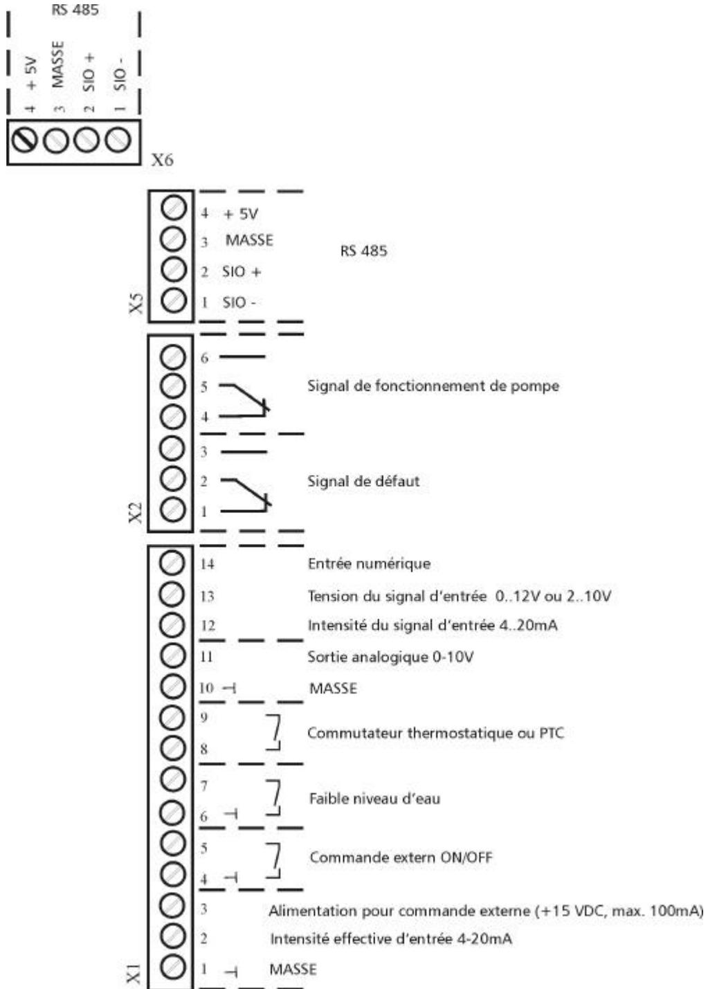
Lorsque vous raccordez les pompes à vitesse variable (max. 4 pompes) via l'interface RS 485, les bornes X5/1/2/3 ou X6/1/2/3 de chaque Hydrovar doivent être raccordées ensemble au moyen d'un câble blindé et programmées en conséquence. (☛ Programmation des séquences des opérations).
