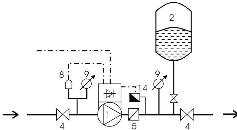
*Schéma de fonctionnement avec une pompe unique*
