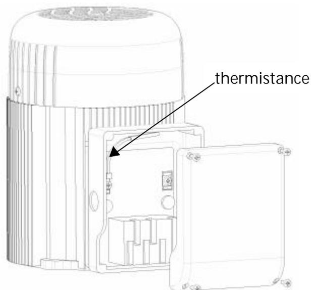
1. Retirez le couvercle de la boîte à bornes ainsi que le bornier intérieur.
