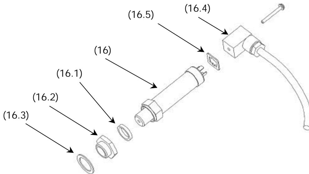
1. Le capteur comporte un raccord G  $\frac{1}{4}$ ". Au besoin, placez le réducteur ( $\frac{3}{8}$ " –  $\frac{1}{4}$ " ) à l'intérieur de la pompe ou de la conduite à l'aide des joints fournis.
