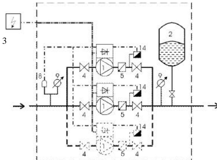
*Schéma de fonctionnement avec plusieurs pompes*
