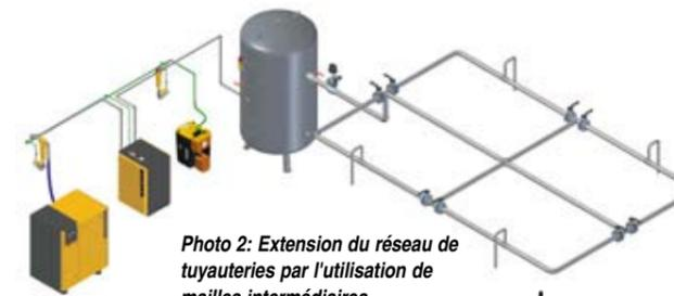
Photo 2: Extension du réseau de tuyauteries par l'utilisation de mailles intermédiaires
