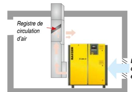
Photo 4: Un registre de circulation d'air à régulation thermostatique assure l'équilibre thermique.
