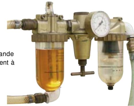
Photo 4: "Energivore": mano-détendeur en décentralisé avec décanteur d'eau
