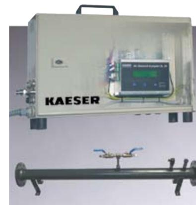
Photo 2: Appareil de mesure de la consommation d'air comprimé. Le débit est déterminé par la mesure de la pression différentielle à l'aide d'un tube gradué dans la conduite de refoulement
