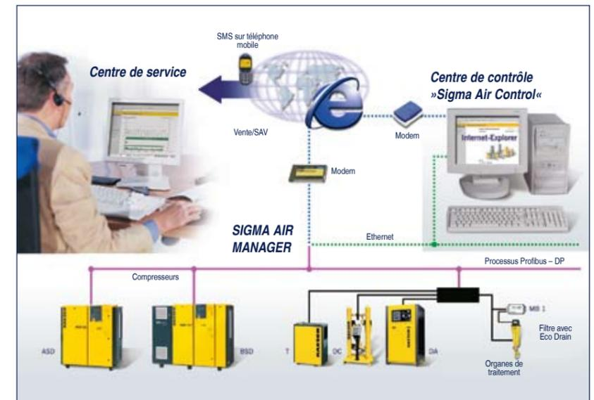
Une technique de transmission des plus modernes est le Profibus. Il permet la transmission rapide de grandes quantités de données sur de grandes distances (Photo ci-dessous). Ainsi, les systèmes de gestion prioritaires ne doivent pas être installés obligatoirement dans la station d'air comprimé.
