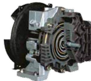
Dans la mesure où les spirales n'entrent jamais en contact, ce processus de compression ne requiert aucune lubrification. Par conséquent, les compresseurs Spiralair garantissent un air comprimé 100 % exempt d'huile.
