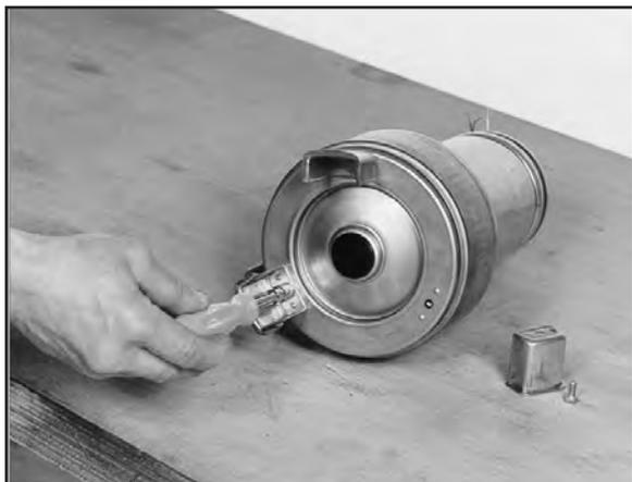
**DX50 (Micro 7)** : desserrer les vis maintenant le pied avec une clé à douille.
