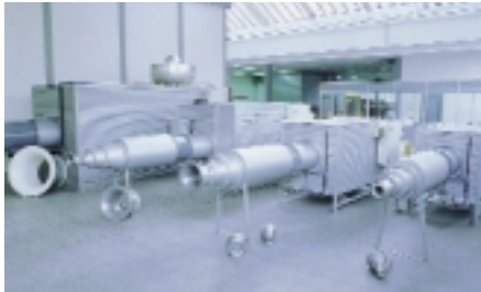
Laboratorio S&P. Túneles de ensayos aerodinámicos. S&P Laboratory. Aerodynamic testing tunnels.
