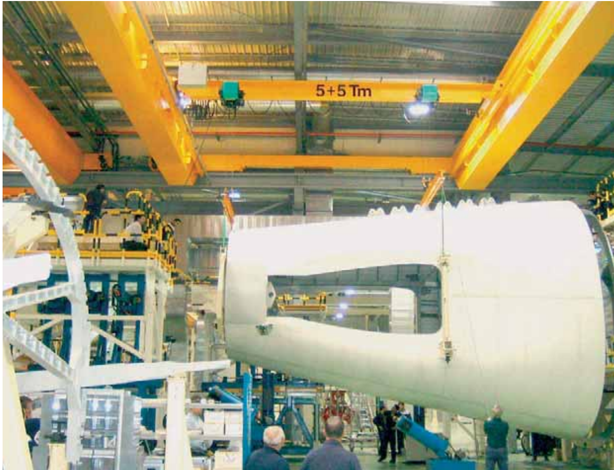
➤ Monorail hauteur perdue réduite (HPR).
